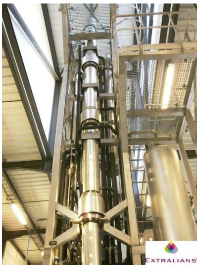
Figure 2: Colonne de fractionnement liquide par CO 2 SC (Extralians)
